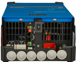
MultiPlus 2000 VA (alt kapak çıkarılmış)
